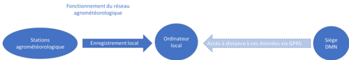
Figure 2 : Représentation schématique du fonctionnement du réseau agrométéorologique (source : auteurs)
