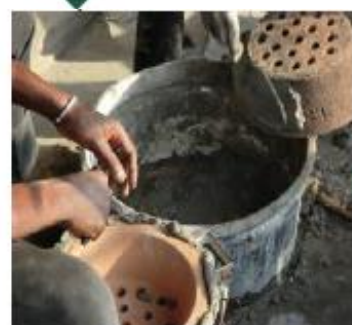
7. Assemblage de l'insert dans la cage avec du ciment
