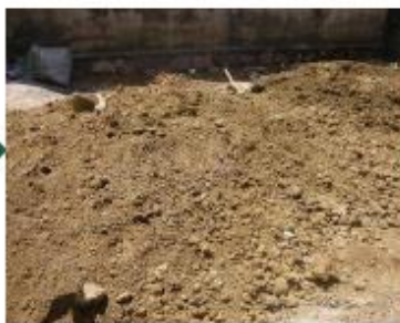
2. l'argile est stockée à l'usine de production d'insert céramique
