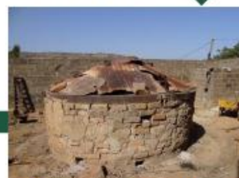
10. les inserts sont cuits dans un four à charbon durant 3 jours
